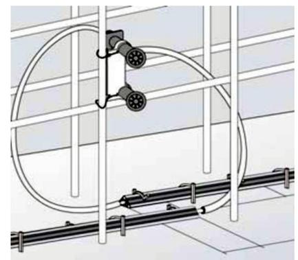
К пакерам подсоединяются соединительные трубки от инъекционных профилей. После этого к пакеру крепятся конические крышки
