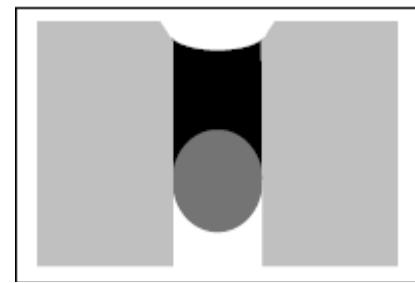
Конструкция шва с выемкой защищает герметик от механических нагрузок.
