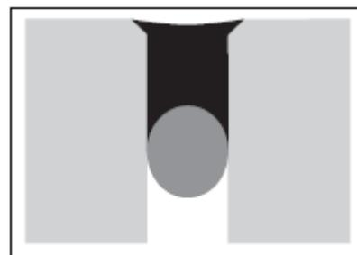
Конструкция заполненного шва исключает риск спотыкания и вовлечение грязи.
