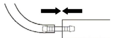
Соединительные трубки отрезаются в необходимый размер в зависимости от требований. Соединение с инъекционным шлангом SikaFuko® Swell 1 осуществляется соединительными ниппелями.
