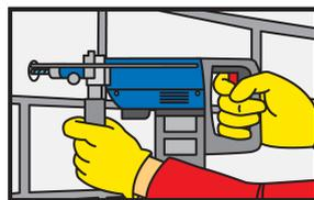
Пробурите отверстие необходимой глубины и диаметра при помощи перфоратора. Диаметр отверстия должен соответствовать размеру крепёжного элемента.
