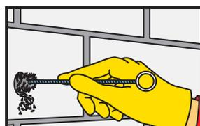
Прочистите отверстие при помощи круглой стальной щётки не менее двух раз. Диаметр щётки должен быть больше диаметра просверленного отверстия.
