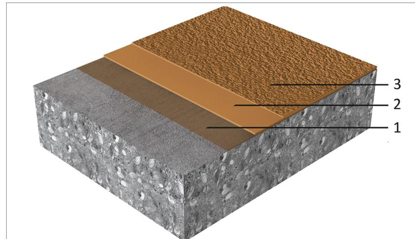
Sikafloor® Pronto RB-27 система (~ 3–5 мм)
