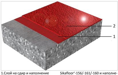
1.Слой на сдир и наполнениеSikafloor\*-156/-161/-160 и наполнение кварцевым песком 0,4-0,7 мм2.Износостойкое покрытиеSikafloor\*-378
