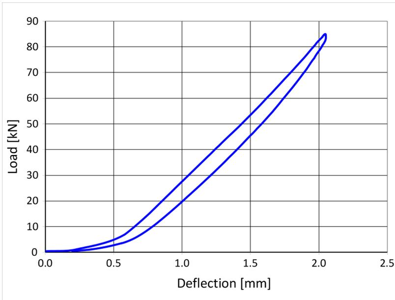
Размеры тестового образца 360 × 160 × 25 мм; аналог статической жесткости по DIN 45673-1.
